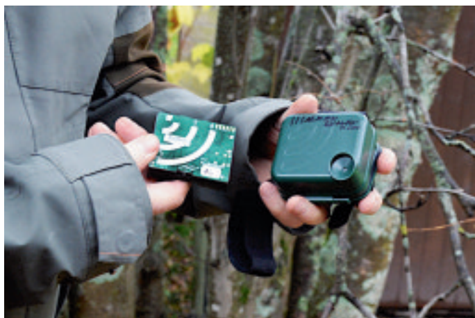
Lepakkodetektorini eli ulträänilaite ja kotelo, kuva Emma Jäderholm
