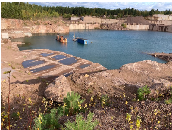
Kuva 2. Lammaskallion tarvekilouhos, Virolahti, 1.10.2023. Hulevesiä muodostuu paljon ja nopeasti pienilläkin louhoksilla (hulevesien peittämä alin ottotaso n. 2000 m 2 ).
